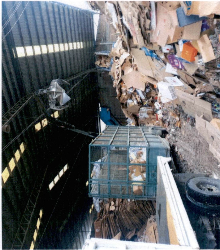
Fotografía 15. Descarga de los documentos mediante grúa de garra metálica sobre la banda transportadora.
