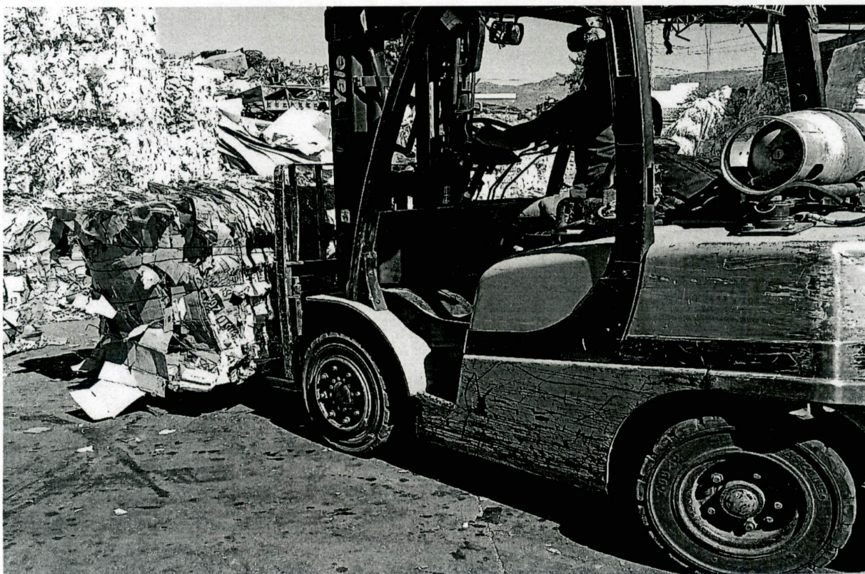
Imagen 6. Mediante un montacargas, los paquetes triturados son trasladados a la zona de carga, donde serán transportados para su reutilización.
