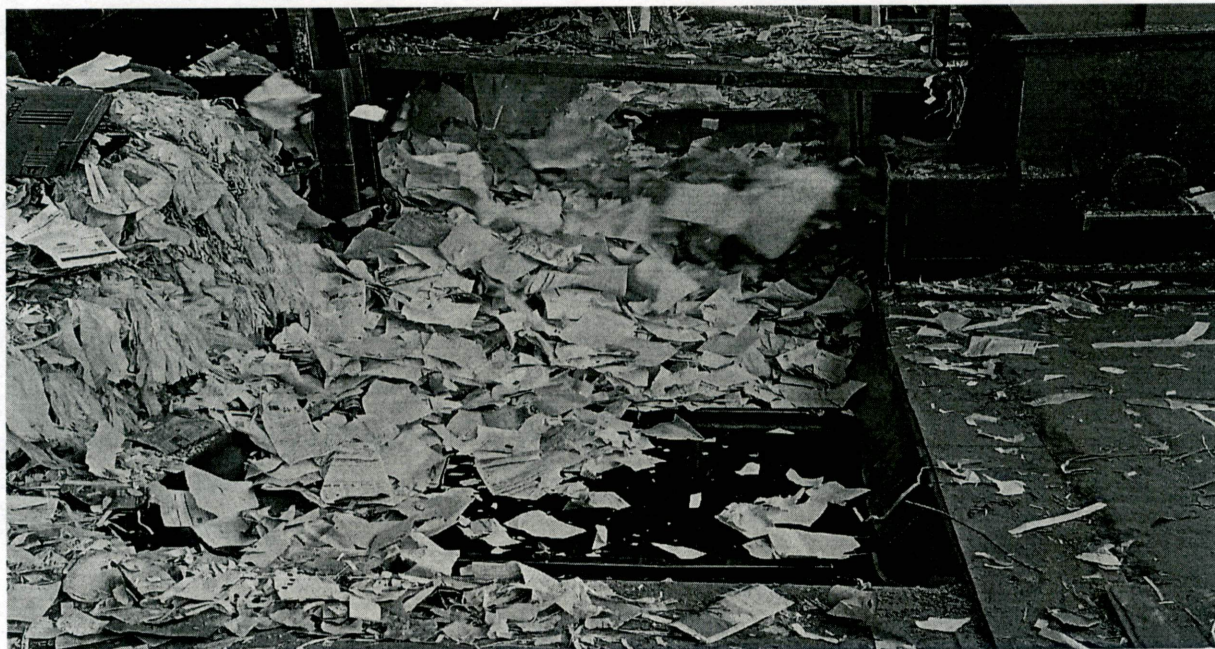
Imagen 2. Los documentos fueron transportados, mediante una banda, a la máquina de trituración.
