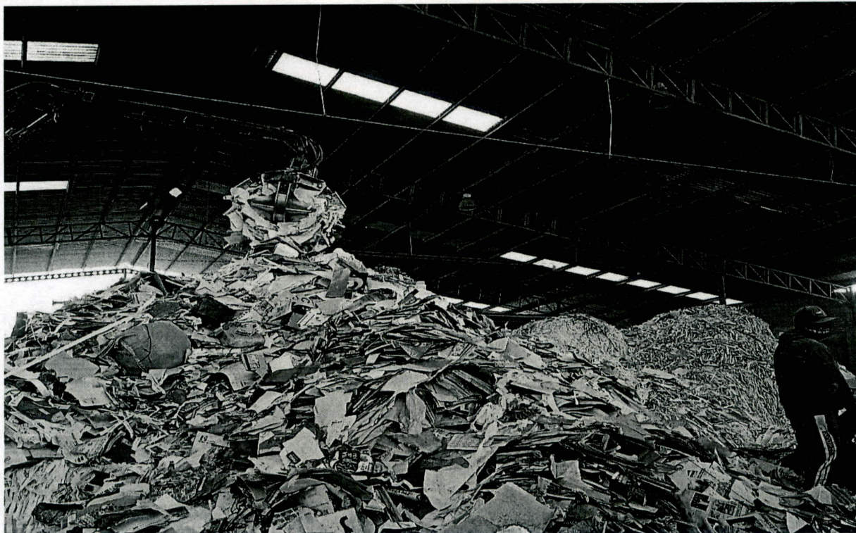
Imagen 1. Los documentos sujetos a baja documental se mezclaron con otros papeles, con el objetivo de proteger la información. De esta manera, mediante una máquina, tipo garra metálica, se revolvieron los documentos para ser transportados a la banda trituradora.
